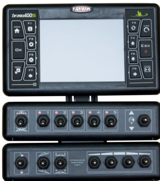
Rysunek 16 Panel sterowania komputera BRAVO 400S.
