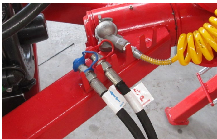
Rysunek 2 Przewody hydrauliczne umocowane prawidłowo.
