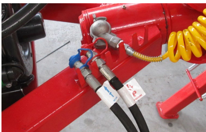
Rysunek 2 Przewody hydrauliczne umocowane prawidłowo.
